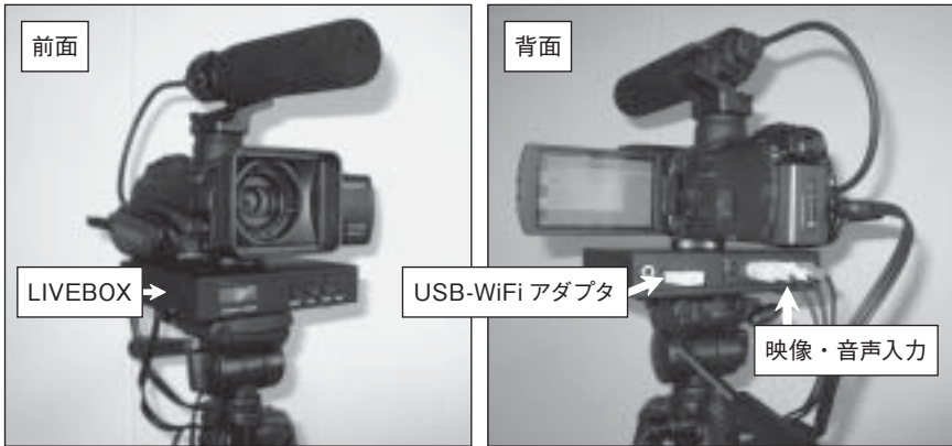
図5 CEREVO社製LIVEBOXを用いた場合の配信機材一式
